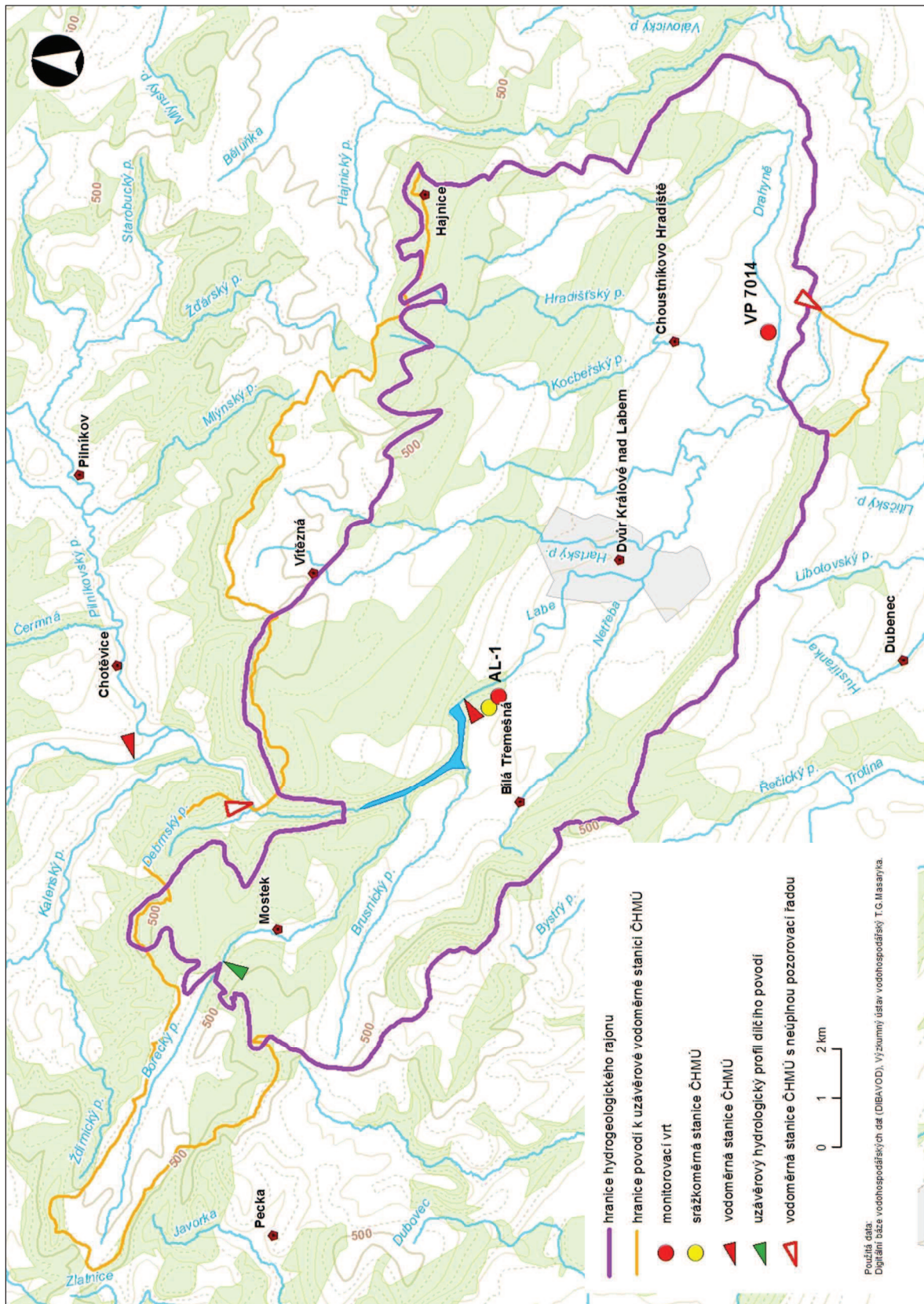
Obr. 3.1: Situace HGR 4240 Královédvorská synklinála s monitorovacími objekty využitými pro stanovení přírodních zdrojů podzemních vod.
