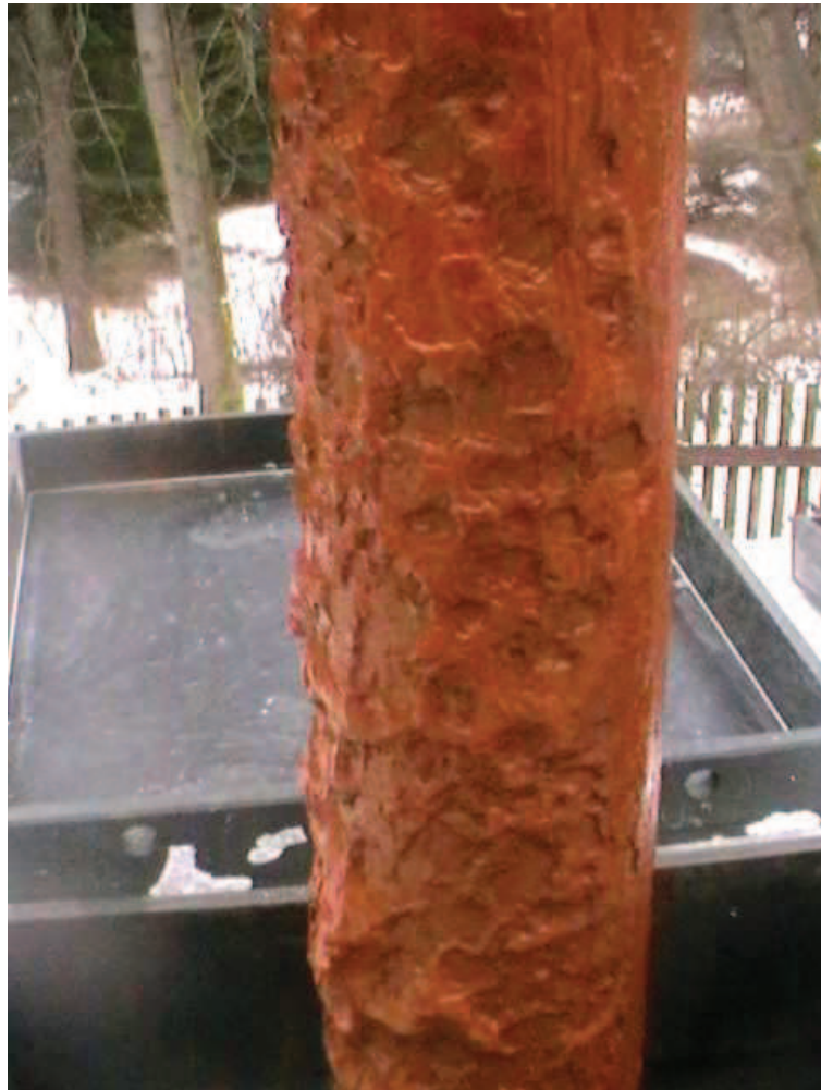
Obr. 1 Oxo-hydroxidy železa na povrchu nerezové výstroje.
